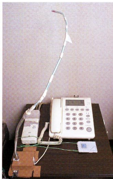
▶息をフツと吹けば親しい人に連絡が。使いやすいよう吹き口をストローで延長
